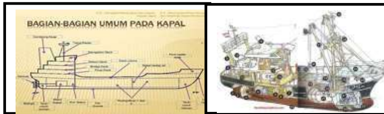
Gambar 5.2: Bagian-Bagian Umum pada Kapal dan struktur pada kapal perikanan
