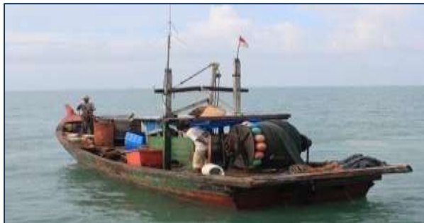
Gambar 5.17. Kapal gillnet dengan drum net
