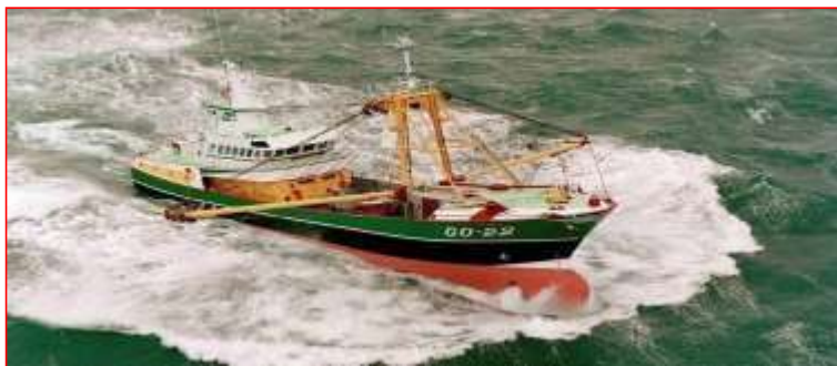
Gambar 5.19. Beam trawl, 484 GT, dengan boom 9 m yang dibuka di sisi kapal
