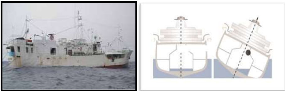
Gambar.5.1 Bentuk kapal ikan dan stabilitas kapal
