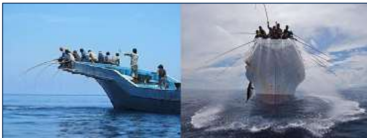
Gambar 5.16. Kapal pole and line tempat pemancing di haluan kapal
